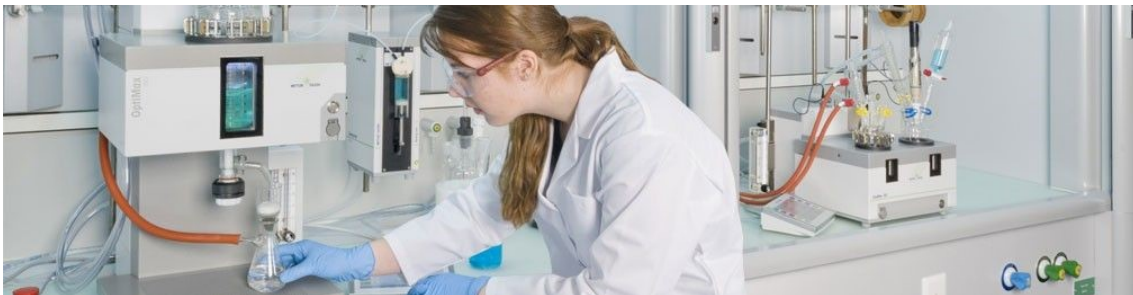
Figura 8. Sistema de reatores de batelada que substitui balões de fundo redondo e reatores encamisados (como exemplo). Fonte: Site da MettlerToledo [5].
